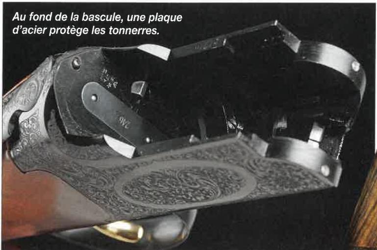
*Au fond de la bascule, une plaque d'acier protège les tonnerres.*
