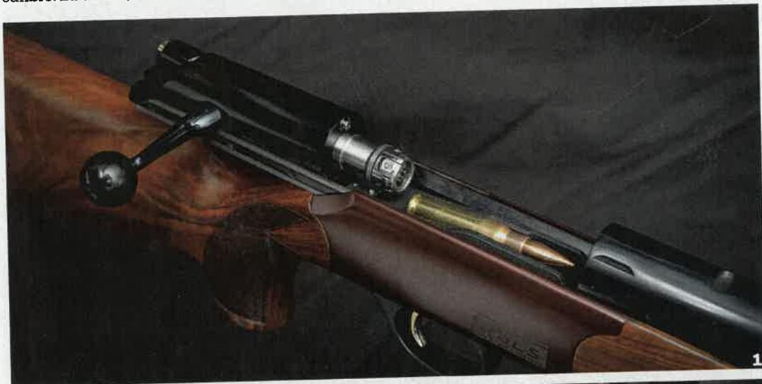
**1** L'otturatore a trazione rettilinea ha elementi indubbiamente comuni al progetto Blaser R93, ma la chiusura è completamente originale.
