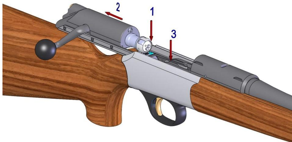
Si le Chargeur est engagé dans la carabine une étape préalable est alors nécessaire. Appuyer d'abord sur le chargeur -3- de façon à pouvoir reculer la culasse mobile jusqu'à la butée maximum -1-.
