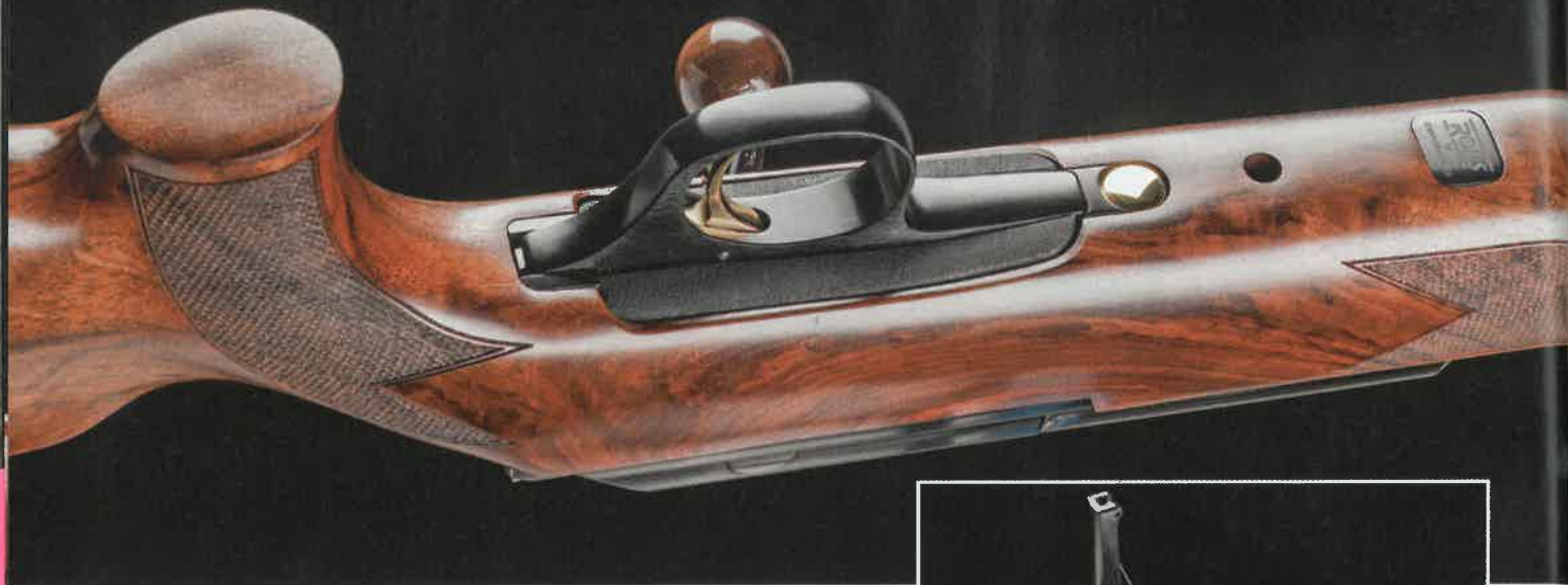
La pièce métallique devant le puits de dépose du canon cache la vis de fixation du boîtier.
