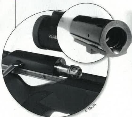
④ Le chargeur reçoit 4 cartouches en calibres std, et 3 en mag... Il s'insère sous le pontet qui bascule lors de l'ouverture.
