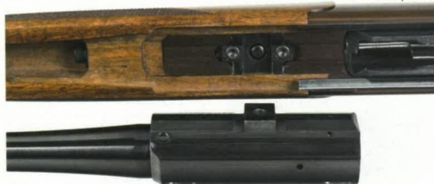
Le changement de canon est aisé, une seule vis à desserrer.
