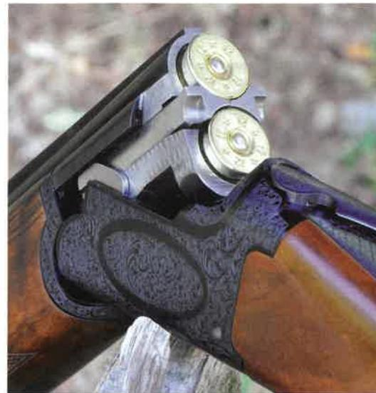
L'arme basculée et chargée montre une partie de son mécanisme et notamment le dégagement des extracteurs/éjecteurs de 9 millimètres.
