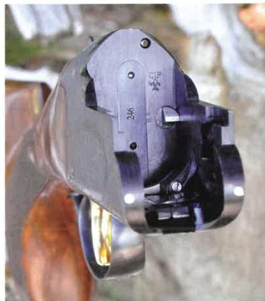
La bascule vue de face : notez une partie de système de verrouillage ainsi que le renfort de la tranche de bascule.
