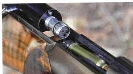
**Détail sur la tête de la culasse et la cuvette de tir. Gros plan sur l'extracteur à griffe et les deux bonhommes sous tension de ressorts assurant l'éjection des douilles.**
