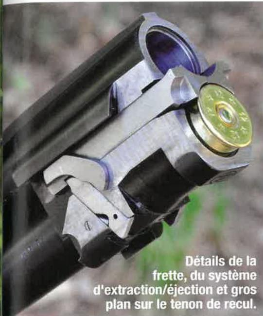
Détails de la frette, du système d'extraction/éjection et gros plan sur le tenon de recul.
