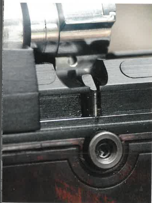
Le poussoir de déblocage du chariot de translation de la culasse.
