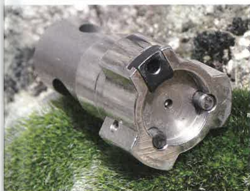
La tête de culasse de la Challenger. Bien évidemment il existe une variante pour chaque type de calibre.
