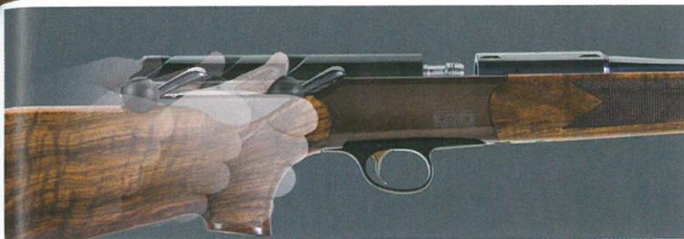
Le réarmement est fluide. Une rampe d'effacement fonctionne avec le coulissement de la culasse. Lorsque cette dernière avance, le chargeur redescend légèrement dans la carcasse pour éviter une sensation de point dur liée au passage de la munition entre le chargeur et la chambre du canon.
