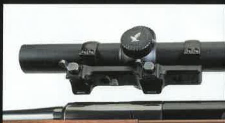
A Chapuis Rols golyósokra a céltávcső (hasonlóan az R8 puskához) „nyeregszereléssel” rögzíthető. A szerelékrogzító karmok a csőfartoldal felső vállába bemart négy nűtba illeszkedve, egy forgóretesz segítségével rögzíthetők
