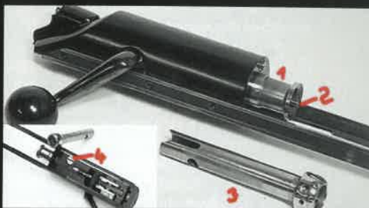
A zárttestbe szerelt, mozgatható peremes reteszelőhüvelyben (1) az ütőszeg (2) látható. A reteszelőhüvelybe behelyezett zárdugattyútest (3) rögzítése célszerszámmal, egy „fool proof” fejú, két irányba elmozdítható csavarral (4) történik
