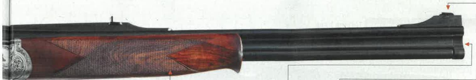
**4** Bouche: tenu par une bague, le canon inférieur reste flottant pour permettre un réglage de convergence aisé.
