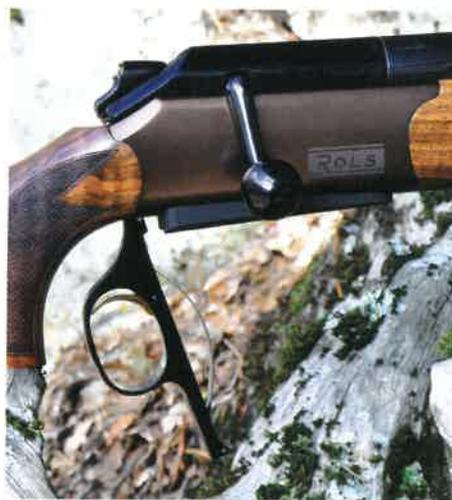
**En basculant la sous garde, on libère le chargeur qui reste maintenu par une griffe l'empêchant de tomber au sol. Il faut appuyer de nouveau sur le bouton d'ouverture pour récupérer le chargeur.**
