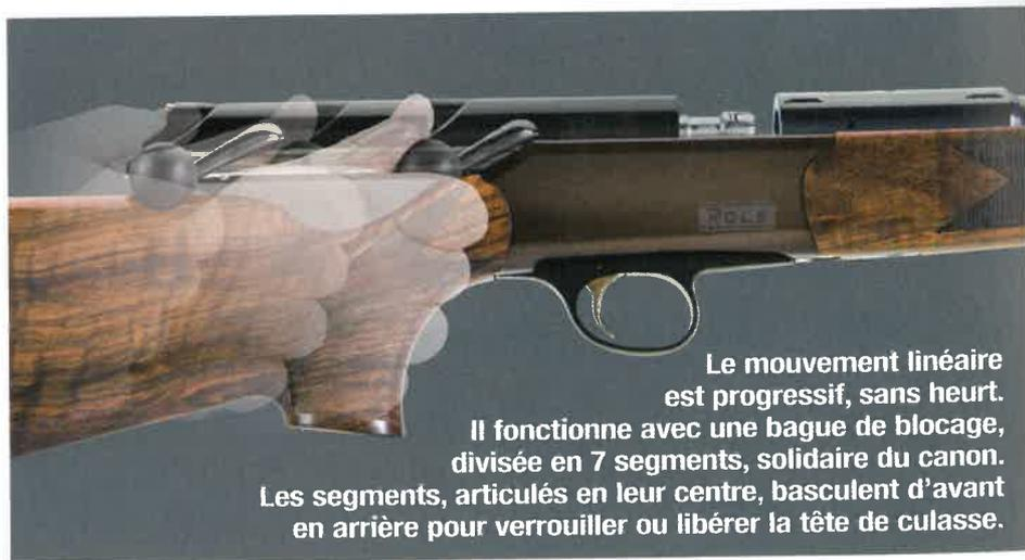
Le mouvement linéaire est progressif, sans heurt. Il fonctionne avec une bague de blocage, divisée en 7 segments, solidaire du canon. Les segments, articulés en leur centre, basculent d'avant en arrière pour verrouiller ou libérer la tête de culasse.
