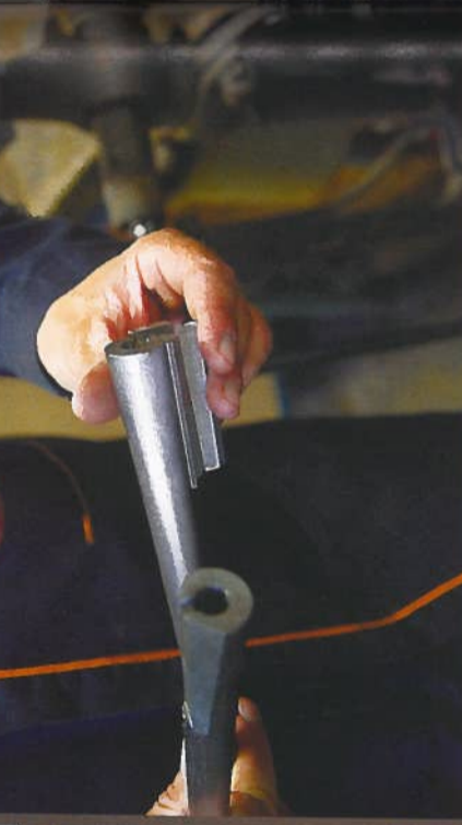
13 L'armurier ajuste les canons sur le berceau (ou planche), le canon droit ne peut pas aller à gauche et inversement. Une face plane a été réalisée sous la chambre, l'homme de l'art doit positionner au mieux les différentes pièces.
