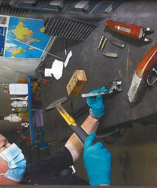
31 Didier Dalex, qui entame sa 34 e année à Saint-Bonnet, poinçonne les armes à la sortie du banc. C'est lui aussi qui réalise la cible d'essai que vous allez trouver dans la boîte contenant votre express.
