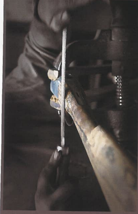
21 Les ébauches des crosses sont dégrossies par des machines avant d'être « approchées » à la plane puis à la râpe à grain de plus en plus fin. La bascule aura auparavant été ajustée à la crosse à la sanguine, l'équivalent rouge du noir de fumée du basculeur.
