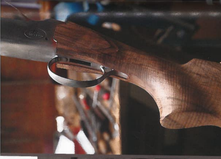
21 Les ébauches des crosses sont dégrossies par des machines avant d'être « approchées » à la plane puis à la râpe à grain de plus en plus fin. La bascule aura auparavant été ajustée à la crosse à la sanguine, l'équivalent rouge du noir de fumée du basculeur.
