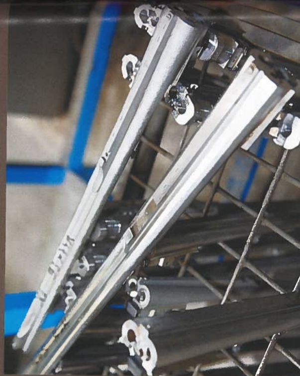
12 La frette berceau, en bas à droite, les deux tubes, la bande intermédiaire monobloc pleine, qui porte la bande de battue et les découpe en queue d'aronde pour la fixation du montage optique, et le crochet de longueur du RGEX avant montage.
