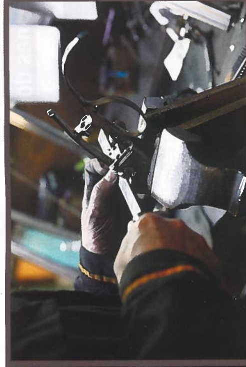
27 Les faces des canons sont soigneusement polies au papier de verre sur la lime. Lorsqu'il ouvrira son arme pour éjecter ses étuis, le possesseur de l'express ne soupçonnera pas le travail minutieux qui a été effectué ici!
