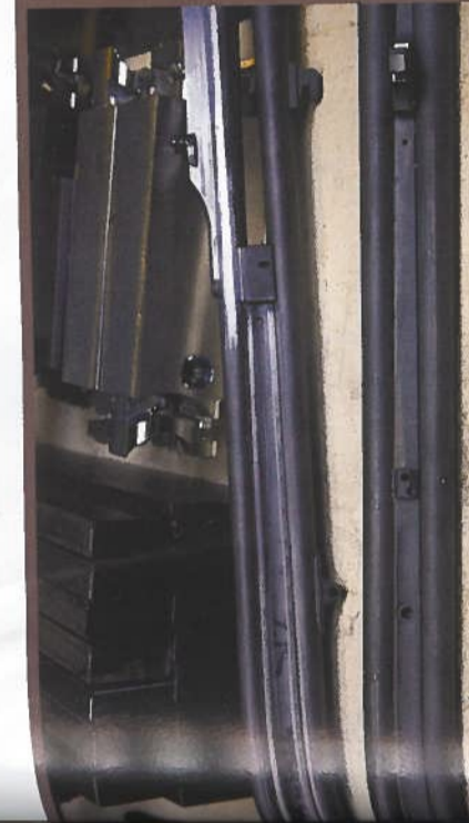
17 Les canons ont été bronzés, en bas ceux du juxtaposé X4, en haut ceux du superposé S12. Au milieu du faisceau de canons, la cale intermédiaire qui va réguler la convergence.
