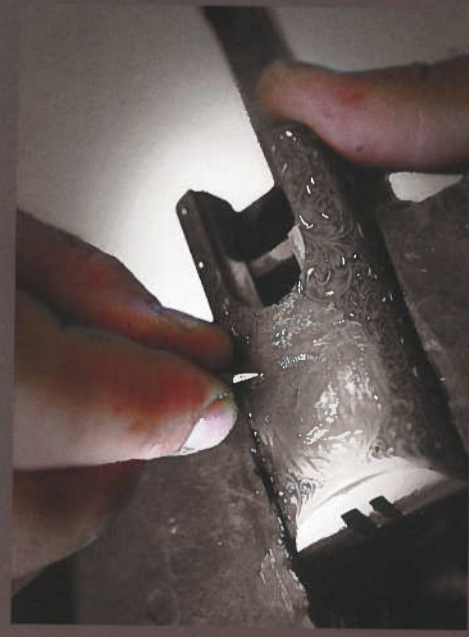
22 Une fois la crosse terminée et relimée, la bascule est démontée pour recevoir la gravure. Celle-ci est réalisée sur un centre laser ou bien confiée, comme ici, aux mains expertes des hommes de l'art, qui pour certains travaillent pour Chapuis depuis plus d'une trentaine d'années.
