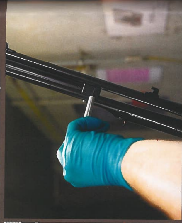
32 Entre l'épreuve et les essais et réglages de convergence, Didier tire en moyenne 30 balles par press. Il règle toutes les armes rayées produites ici. Les press sont éprouvées au banc d'épreuve de Saint-Etienne.
