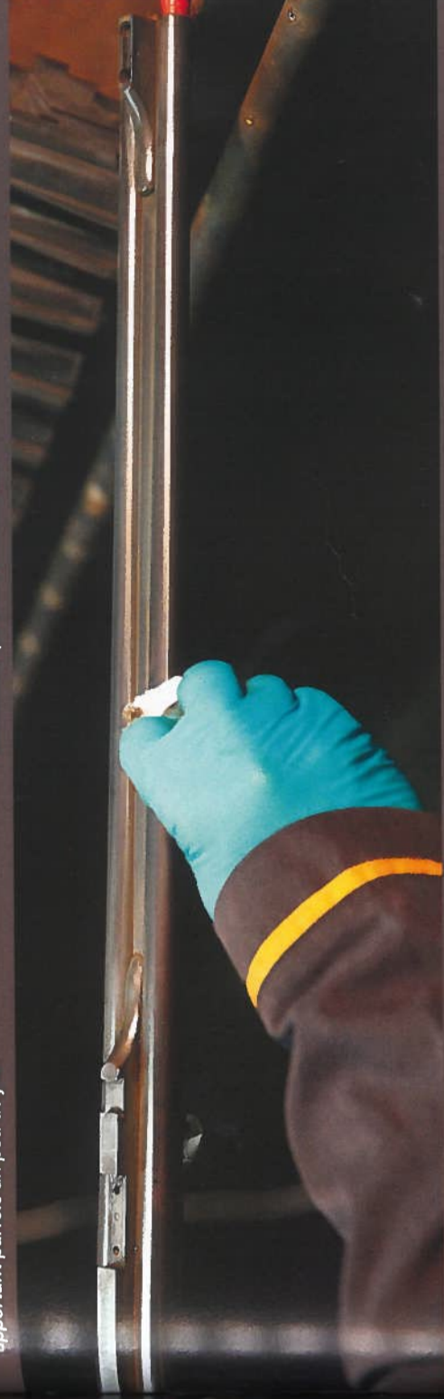
27 Les faces des canons sont soigneusement polies au papier de verre sur la lime. Lorsqu'il ouvrira son arme pour éjecter ses étuis, le possesseur de l'express ne soupçonnera pas le travail minutieux qui a été effectué ici!
