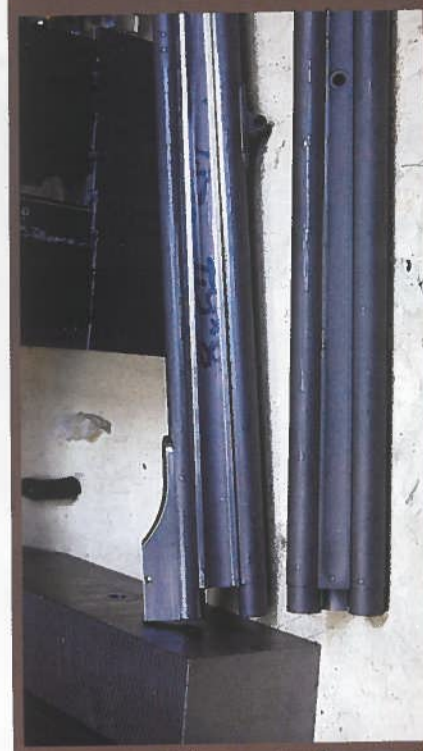
19 La machine cinq axes assure une partie de la relime de la bascule. Des cotes de plus en plus fines sont approchées et limitent le travail au burin des armuriers d'antan. Toutefois, les finitions à la lime et au papier restent de mise et doivent être conduites par des armuriers expérimentés.
