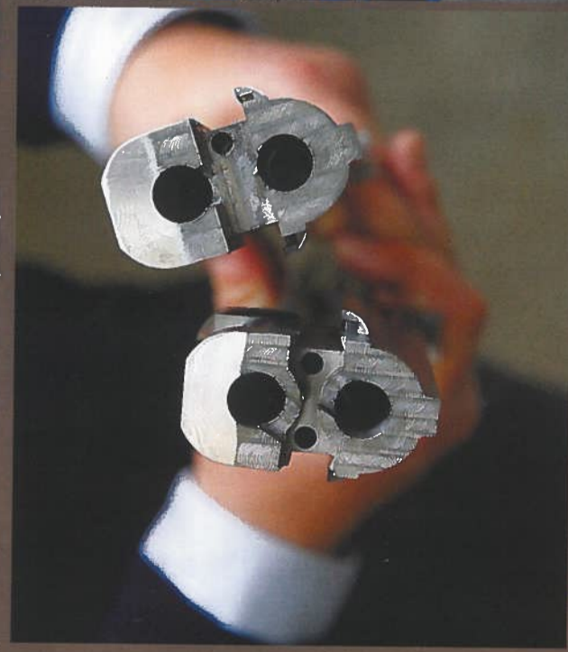
16 À gauche, un jeu de canons superposés de Super Orion, à droite aussi. La différence entre les deux est l'usinage pour le passage des tiges d'éjecteurs et de leurs tire-cartouches, à gauche, et de l'extracteur, à droite. Des machines anciennes complètent l'équipement, certaines sont utilisées pour le passage carré des tiges d'armeur ou pour certains perçages en long.
