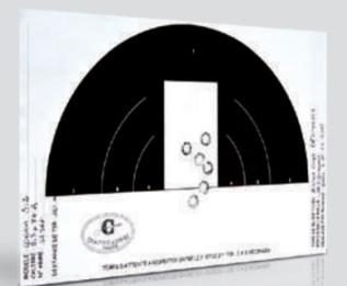
Dispersion obtenue sur six coups tirés à cadence rapide en calibre 9,3 x 74 R. On note une grande stabilité des impacts.
