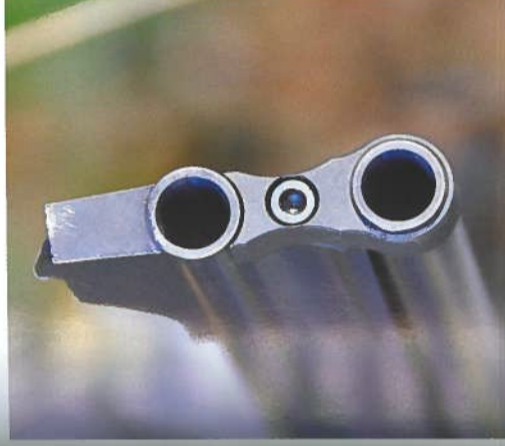
La convergence des tubes est assurée par une cale soudée caractéristique des armes Chapuis.
