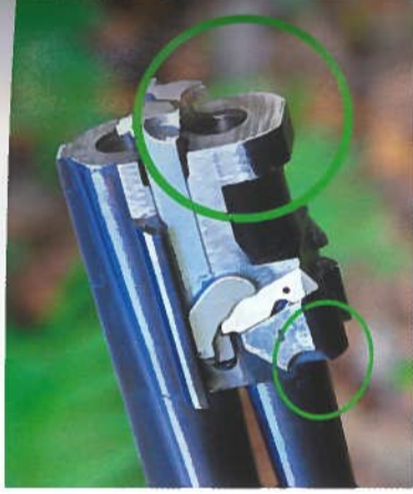
Le bec d'armement de la batterie intervient dès le basculement du faisceau des canons.
