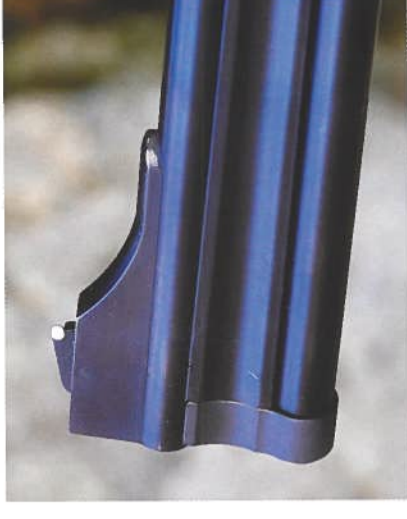
Le guidon monté sur rampe et sur ressort, est réglable en site par le truchement d'une vis.
