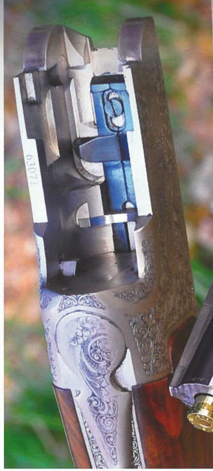
Gros plan sur la frette, en forme de berceau pour le canon du dessus.
