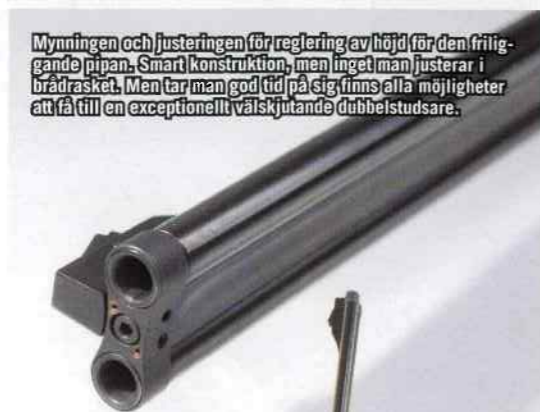
När jag synade pipsetet på vår testbùssa trodde jag först att man slarvat med lödningen på fabriken. Men upptäckte snart att högerpipan är helt friliggande från spången vilken är lödd i den fasta vänsterpipan. En smart lösning på problemet med lödda pipor samtidigt som man bibehåller det klassiska stuket på vapnet.
