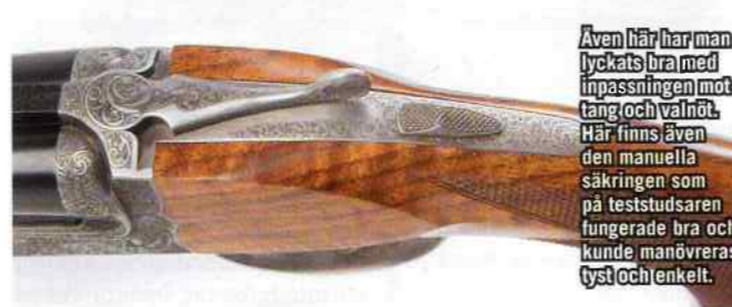
Baskylen är troligen lasergraverad men det är absolut inget fel med det utan den är riktigt trevlig. Notera den fina inpassningen mot både kolvhalsens och framstockens valnöt.
