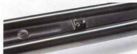
Under framstockens valnöt finns en till justering för sidjustering av den friliggande pipan. Även här finns det flera skruvar samt låsningskruvar vilka kräver lite eftertanke för att man inte skall skruva bort sig.
