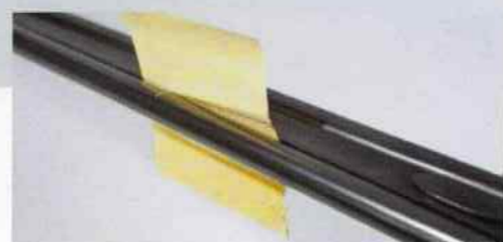
När jag synade pipsetet på vår testbùssa trodde jag först att man slarvat med lödningen på fabriken. Men upptäckte snart att högerpipan är helt friliggande från spången vilken är lödd i den fasta vänsterpipan. En smart lösning på problemet med lödda pipor samtidigt som man bibehåller det klassiska stuket på vapnet.
