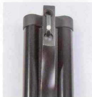
Den väl tilltagna kornfoten med det justerbara kornet. Den uppmärksamma läsaren noterar att kornet sitter placerat mer åt vänster sida och inte helt i mitten. Detta är inget slarvfel utan har att göra med den speciella konstruktionen med friliggande högerpipa. En kanske något udda lösning men funktionell. Dessutom är det ju inte för inte den är fransk.
